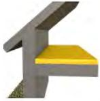
**Ajout d'une isolation sur le plancher des combles perdus : 280 mm de laine minérale en rouleaux - R = 8.7 m<sup>2</sup>.K/W - Surface isolée = 95 m<sup>2</sup>**
