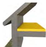
**Ajout d'une isolation sur le plancher des combles perdus : 220 mm de laine minérale en rouleaux - R = 6.8 m<sup>2</sup>.K/W - Surface isolée = 95 m<sup>2</sup>**
