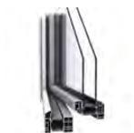
**Remplacement de 4 portes-fenêtres par des menuiseries en alu à rupteur de pont thermique avec double vitrage amélioré - Uw = 1.5 W/m<sup>2</sup>.K - Sw = 0.43**
