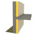
**Remplacement de l'isolation des murs extérieurs par : 120 mm de laine minérale en rouleaux + doublage intérieur - R = 3.7 m<sup>2</sup>.K/W - Surface isolée = 128 m<sup>2</sup>**
