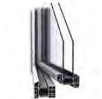
**Remplacement de 4 fenêtres par des menuiseries en alu à rupteur de pont thermique avec double vitrage amélioré - Uw = 1.5 W/m<sup>2</sup>.K - Sw = 0.55**
